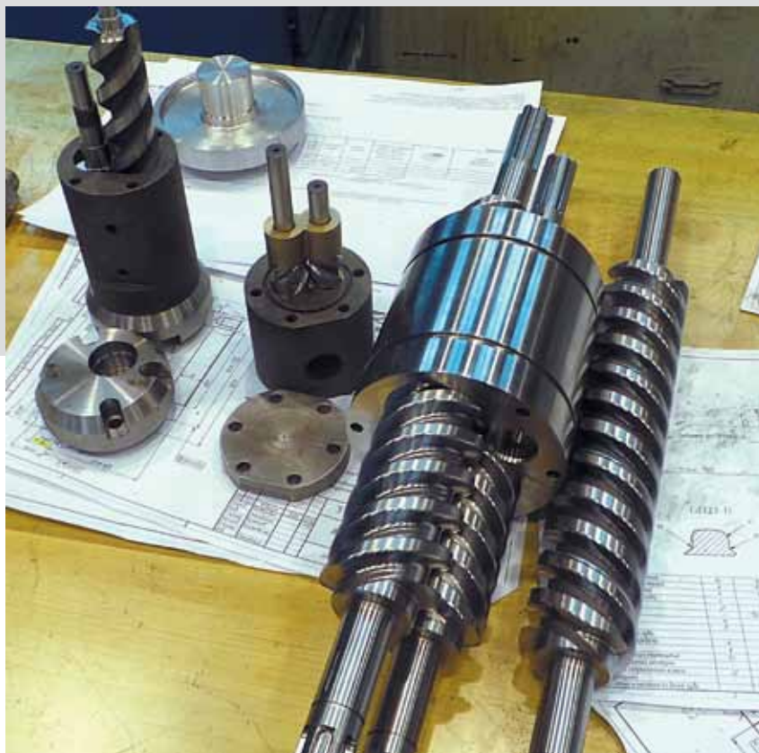
ЭЦ винты насосов. Новый вид эксцентриково-циклоидного зацепления зубчатых колес, передаваемый момент которого почти в 2 раза превосходит звольвентные передачи, не уступает им по КПД
