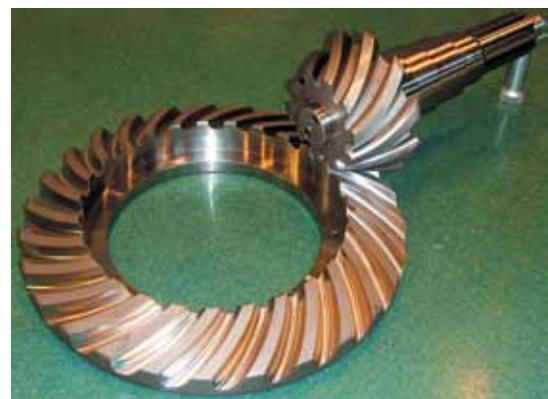
ЭЦ для БелАЗа 7555. Главные передачи для «БелАЗа» прошли стендовые испытания с рекомендацией к применению
